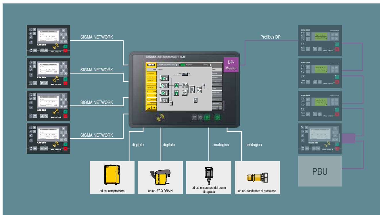
Stazione d'aria compressa gestita dal SIGMA AIR MANAGER 4.0 – Possibilità di connessione
